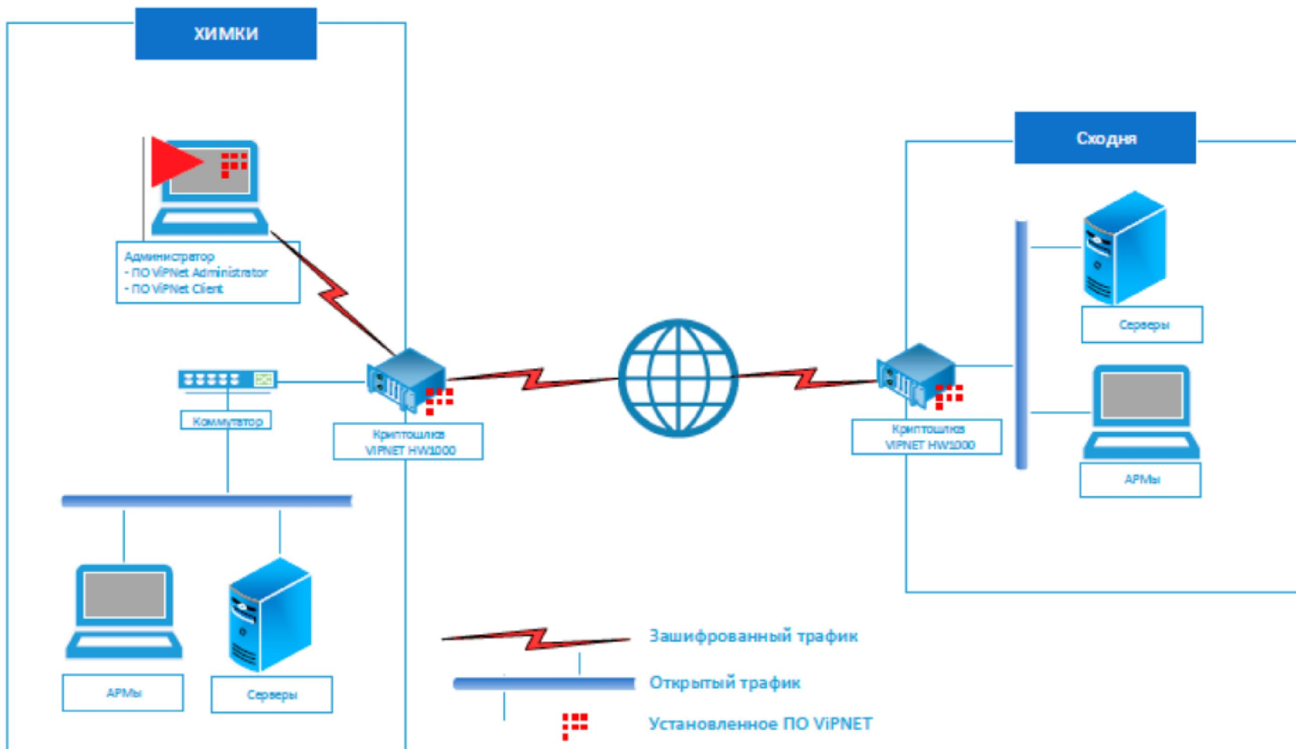
При необходимости защиты канала связи между АРМом или сервером и Координатором HW1000 необходима установка ViPnet Client на АРМ или сервер
